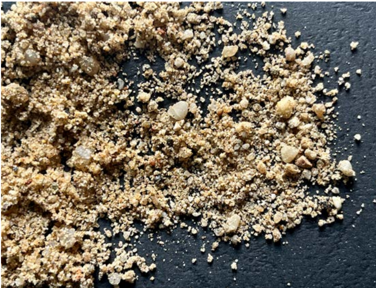
ryc. 3 Kruszywo odpowiednie do zapraw wapiennych. Piasek kopany, płukany, ostroziarnisty o różnej frakcji ziaren. Nadaje się do tynków zewnętrznych i pierwszej warstwy tynków wewnętrznych. Przed dodaniem do zaprawy przeznaczonej do wierzchniej warstwy tynków należy go przesiać
