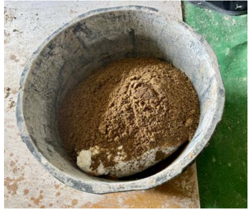
ryc. 10 Stopniowe dodawanie odmierzonej ilości kruszywa
