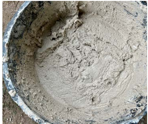
ryc. 12 Konsystencja wymieszanej zaprawy tynkarskiej, bez dodatku wody
