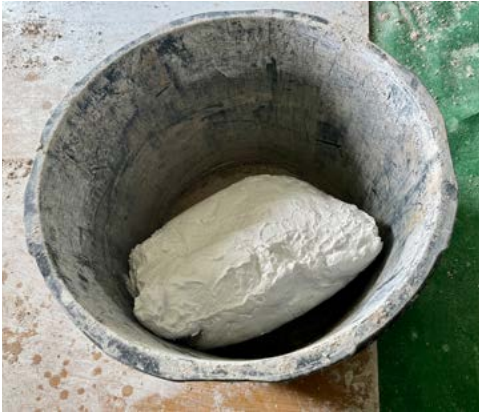
ryc. 9 Ciasto wapienne po wylaniu z worka
